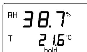
При нажатии MODE или ENTER (ВВОД) дисплей возвращается в свое обычное состояние.
