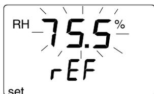
Каждым нажатием кнопки значение изменяется на 0.1 %. Если Вы будете удерживать кнопку нажатой, значение будет меняться в убыстренном режиме. Нажмите ENTER и индикатор НМІ41 отобразит значение, которое в данный момент измеряет датчик, при этом на дисплее появится сообщение, подобное следующему:
