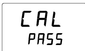
Таким образом откорректированные данные рассчитаны и сохранены в память НМІ41. НМІ41 автоматически возвращается к выбору единиц отображения и может быть выключен. При использовании данного индикатора в качестве обычного измерительного прибора и корректировочные данные отличаются от заводских установок, в правом верхнем углу появится следующее:
