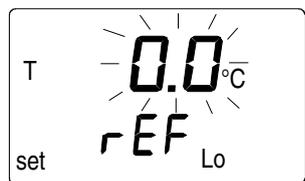
Мигающий номер означает, что значение образца низкой температуры сохранено в памяти НМІ41. Вставьте датчик в образец низкой температуры. Измерьте действительную температуру репера и измените показания на дисплее кнопками  $\sigma$  и  $\tau$  для приведения их в соответствие точному значению, например:
