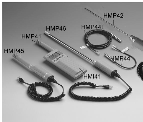
Индикатор HMI41 отображает информацию об относительной влажности, температуре и температуре точки росы. Кроме того, можно выбрать для отображения один из следующих параметров: абсолютная влажность, температура шарика смоченного термометра или отношение смеси.
