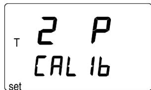
Для включения режима калибровки измерения температуры по двум точкам нажмите ENTER. На дисплее появится сообщение, подобное следующему, при этом его первая линия будет мигать:
