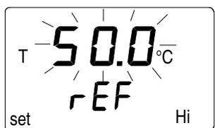
Мигающее число обозначает, что репер высокой температуры сохранен в памяти НМІ41. Вставьте датчик в образец высокой температуры. Снимите показания реперной температуры и отрегулируйте показания на дисплее при помощи кнопок  $\sigma$  и  $\tau$ , приведя их в соответствие с точными значениями, например:
