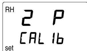
Для включения режима калибровки измерения влажности по двум точкам нажмите ENTER. Сообщение, похожее на следующее, появится на дисплее, при этом его первая линия будет мигать:
