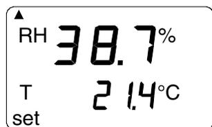
Это режим измерения со включенной функцией сбора данных. Его можно отличить от режима обычного измерения появлением в левом нижнем углу дисплея сообщения 'SET'. Показания на дисплее обновляются раз в минуту, а дисплей не освещен для снижения потребления питания, за исключением моментов этих обновлений. При выключении индикатора измерения, сохраненные до этого момента остаются в памяти, и их можно прочесть, включив индикатор в режим REC READ (см. Раздел 6.5).
