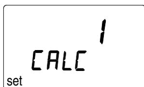
НМИ41 отображает показания относительной влажности, температуры и температуры точки росы. Кроме того, может быть выбрана один из следующих параметров: абсолютная влажность, температура смоченного термометра и **отношение смеси**. Цифра на дисплее обозначает следующие параметры:
