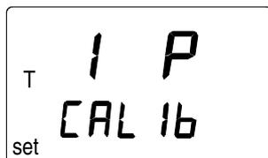
Нажмите ENTER для включения режима калибровки измерения температуры по одной точке. На дисплее появится следующее сообщение, при этом первая его строка будет мигать:
