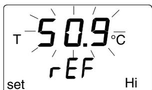
Нажмите ENTER, НМІ41 отобразит измеряемое в данный момент датчиком значение, на дисплее появится сообщение, аналогичное следующему:
