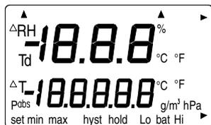
Затем отпустите кнопку ON/OFF и в течение 1 - 2 секунд одновременно нажимайте кнопки ENTER и MODE до появления на дисплее следующего сообщения:
