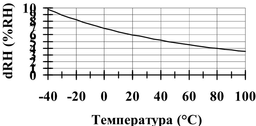
**Рисунок 2.1** Погрешность измерения при относительной влажности  $100\text{ \%}$  и при разнице температур окружающей среды и датчика в  $1\text{ }^{\circ}\text{C}$
