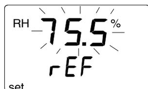
Нажмите ENTER, при этом индикаторе НМІ41 отобразит измеряемое в данный момент датчиком значение, на дисплее появится сообщение, подобное следующему:
