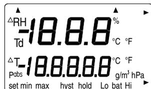
Отпустите кнопку ON/OFF и сразу же нажмите кнопку HOLD. На индикаторе будут отображены версия используемого программного продукта и тип датчика, после чего дисплей автоматически переключится на изображение заряженности батарей:
