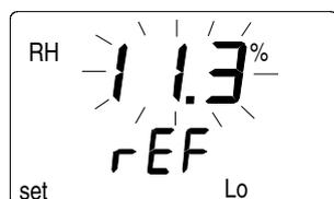
Нажмите ENTER, при этом НМІ41 отобразит значение, которое в данный момент измеряется датчиком, на дисплее появится сообщение, подобное следующему:
