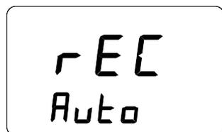
Это основное состояние дисплея в режиме сбора данных. Вы можете включить режим REC CATCH при помощи кнопки MODE (ручной сбор данных, см. Раздел 6.2), а повторным нажатием MODE - режим REC READ (показания результатов измерений, см. Раздел 6.5). Нажатием ENTER, Вы можете установить продолжительность измерения, а повторным нажатием ENTER, интервал между измерениями (Разделы 6.3 и 6.4).
