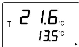
Температура и **температура шарика смоченного термометра**; стрелочка в правом нижнем углу дисплея указывает на то, что
