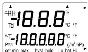
Через несколько секунд на дисплее отобразятся версия используемого программного продукта, а затем тип применяемого датчика (41.45 или 42.46):
