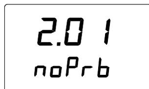
Если не высвечивается версия программы, значит она ниже, чем 1.02, и индикатор не может использоваться с датчиком НМР46. Если не появляется тип датчика, то либо индикатор, либо датчик относятся к предыдущей версии, и автоматическое распознавание невозможно; введите установки вручную (см. Раздел 8).
