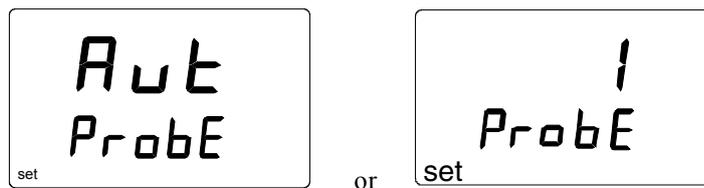
В индикаторах с маркировкой ID автоматическое определение типа датчика установлено по умолчанию (AUT PROBE), а на предыдущих версиях – на тип датчика 1. Если индикатор автоматически не распознает тип датчика, **при использовании НМР46, установите его вручную на 2.** Если изменение типа датчика не требуется (для измерителей НМР41/45), выключите индикатор.
