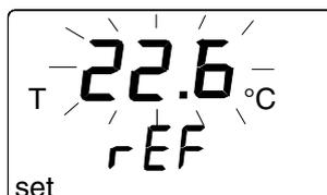
Нажмите ENTER, индикатор НМІ41 отобразит значение, измеряемое датчиком в данный момент, на дисплее появится сообщение, сходное со следующим:
