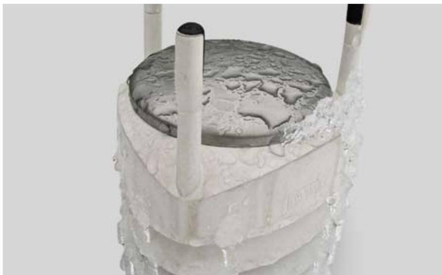
Прибор WXT520 имеет цепь автоматического управления, включающую обогрев при низких температурах.
